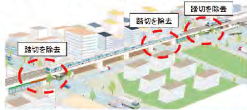
連続して高架化することで踏切を一挙に撤去
